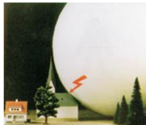
Bild 2: Eine Kugel mit einem Radius von 45 m kann – wie in dieser Modelluntersuchung gezeigt – nicht nur die Turmspitze sondern auch das Kirchenschiff an mehreren Stellen berühren. An allen Berührungsstellen sind Einschläge möglich.
