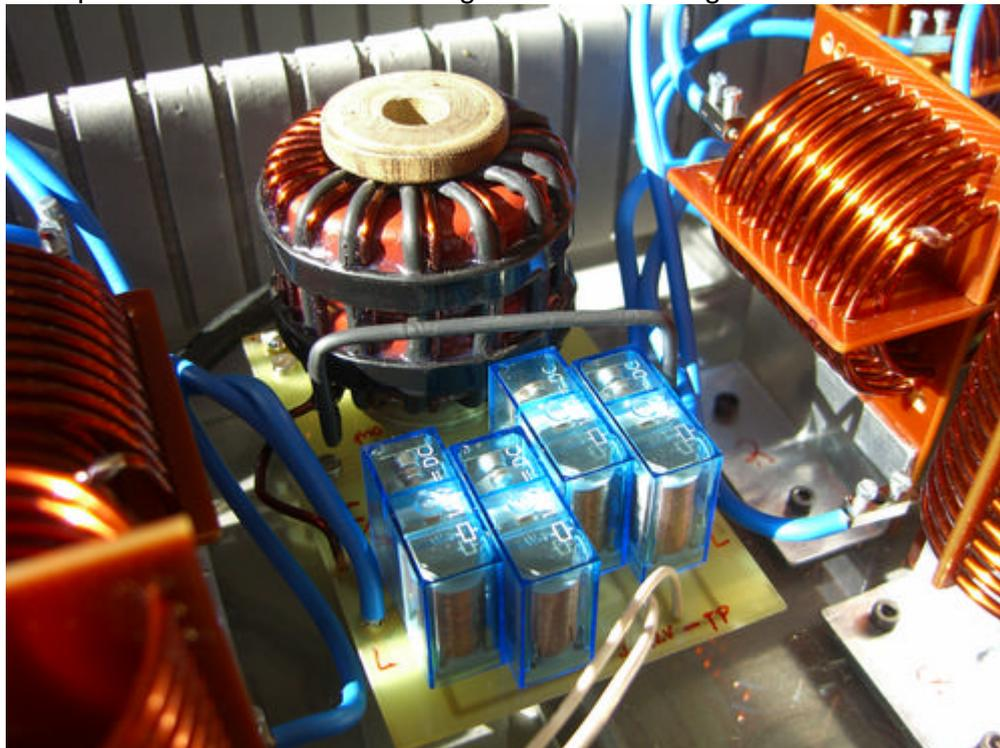
Die Balun Platine fertig integriert im Koppler.
