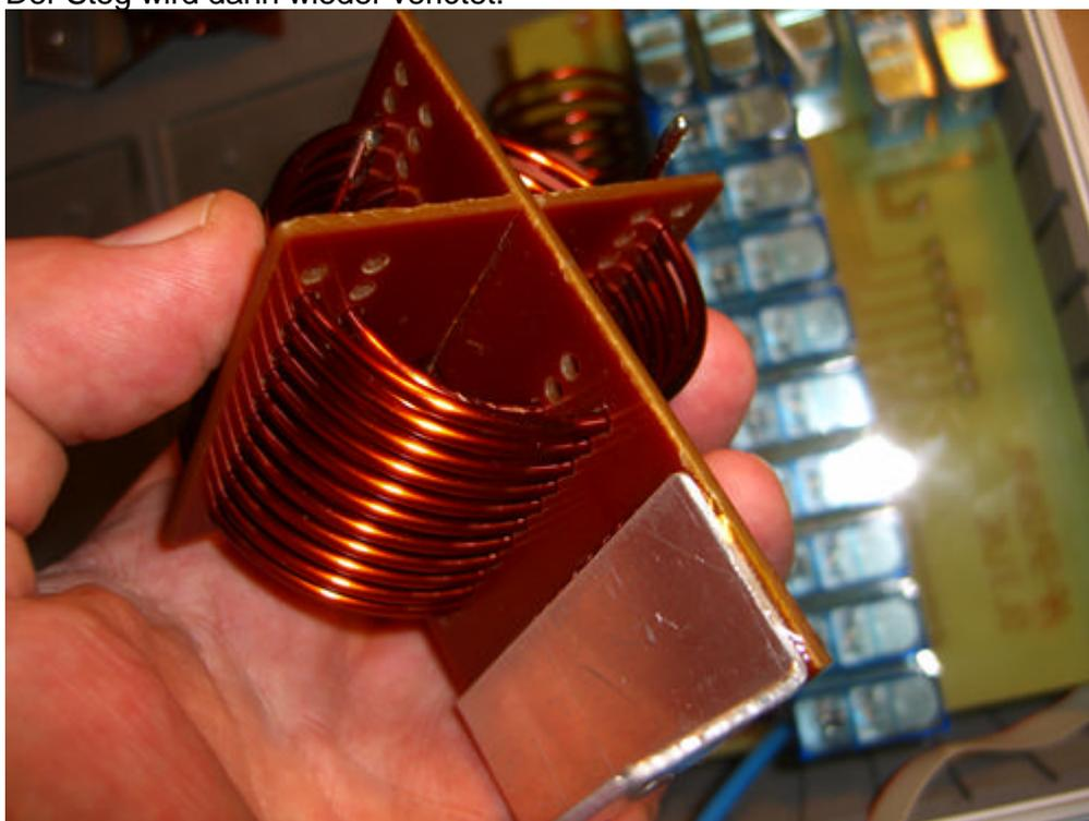
L6 Spulenkreuz fertig konfektioniert mit Montagewinkel (geklebt). Es hat sich gezeigt dass ein Bohrungsdurchmesser 2.5mm ideal für die Einbringung des Drahtes ist und der Spule trotzdem keinen Raum zum Wackeln lässt.
