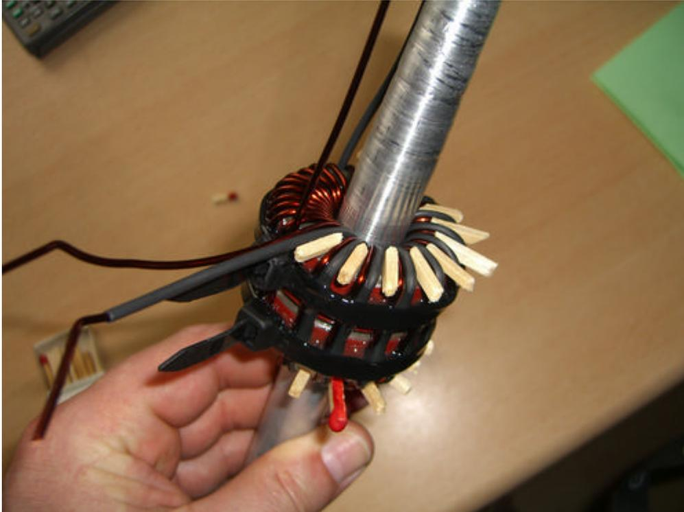
Oben der Balun nach dem Verkleben. Die Streichhölzer bringen die bifilare Wicklung in die erwünschte Anordnung. Zur Sicherung der Windungen wurden zwei Kabelbinder verzurrt und großflächig verklebt. Der Alu Dorn diente zur besseren Handhabung und wurde nach dem Aushärten entfernt.
