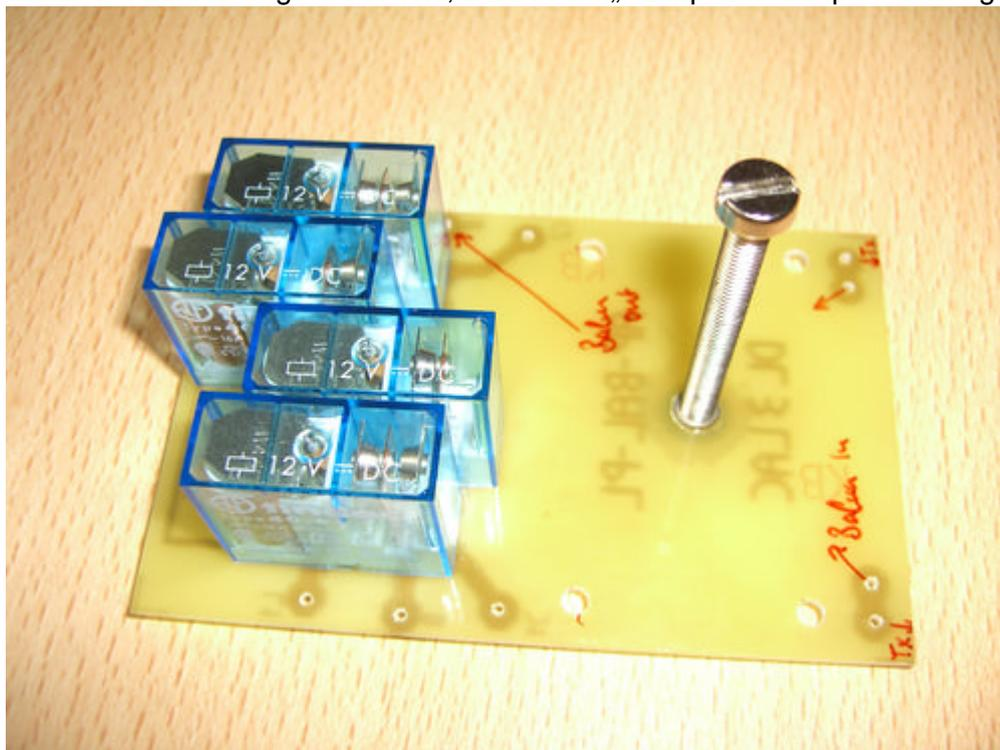
Die Spannschraube ist aus Messing und fußt in einer geklebten M5 Buchse.
