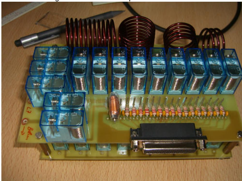
Das L/C Modul mit dem 25 pol. Anschluss für die Steuereinheit. OM Adam hat L1-4 gewickelt.
