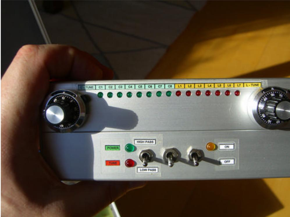
Vorderseite, Schalter von Links nach Rechts: HP/TP – PA Verriegelung - Ein/Aus
