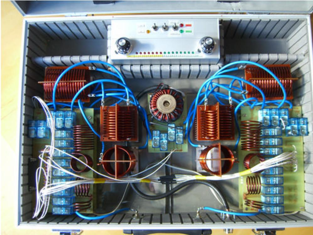
Das Steuergerät wird zum Betrieb entnommen und steht zur Bedienung im Shack. Der Koppler ist streng symmetrisch aufgebaut. Die unsymmetrische Speiseleitung wird im Balun symmetriert und auf die L/C Module links und rechts aufgeteilt. Die Relais schalten die Induktivitäten und Kapazitäten sukzessive hoch bis sich ein brauchbares VSWR einstellt. Leider hat OM Krebs keine automatische Abstimmung nicht vorgesehen. Das wäre eine sinnvolle Verbesserung.
