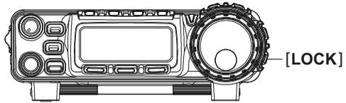
In der werksseitigen Voreinstellung wirkt die Betätigung der **LOCK**-Taste nur auf den Hauptabstimmknopf **DIAL**. Die anderen Tasten und Schalter bleiben unverriegelt. Um die Regler und den **SELECT**-Knopf mitzuverriegeln, muss im Menü Nr. 054 [LOCK MODE] folgende Einstellung vorgenommen werden.
