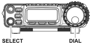
Die Abstimmungsschrittweite des Synthesizers, mit welcher der **SELECT**-Knopf die Frequenz verändert, lässt sich unabhängig für jede Betriebsart programmieren. Dies geschieht im Menü No-006 [AM STEP] für AM, No-052 [FM STEP] für FM und No-082 [SSB STEP] für SSB, CW und die Digital-Modi. Weitere Informationen dazu auf den Seiten 97, 105 und 111.
