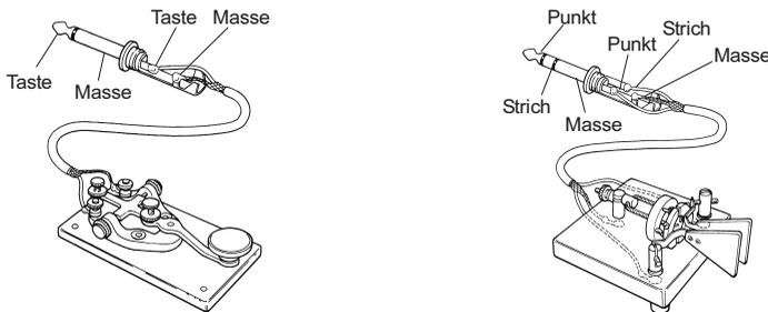
Für den Betrieb mit einer normalen Morsetaste werden nur die Anschlüsse von Mitten- und Außenkontakt benötigt.
