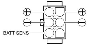
An dieser Buchse befindet sich außerdem ein Anschluss zur Umschaltung der Sendeleistung. Wenn Pin 3 (BATT SENS) an Masse gelegt wird, schaltet der **FT-857D** die Sendeleistung automatisch auf 20 W (430 MHz: 10 W) herab.
