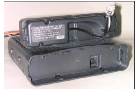
Mit abgesetzt betriebsfähigem Bedienteil und am Bedienteil selbst anschließbarem Mikrofon bieten sich vielfältige Montagemöglichkeiten.
