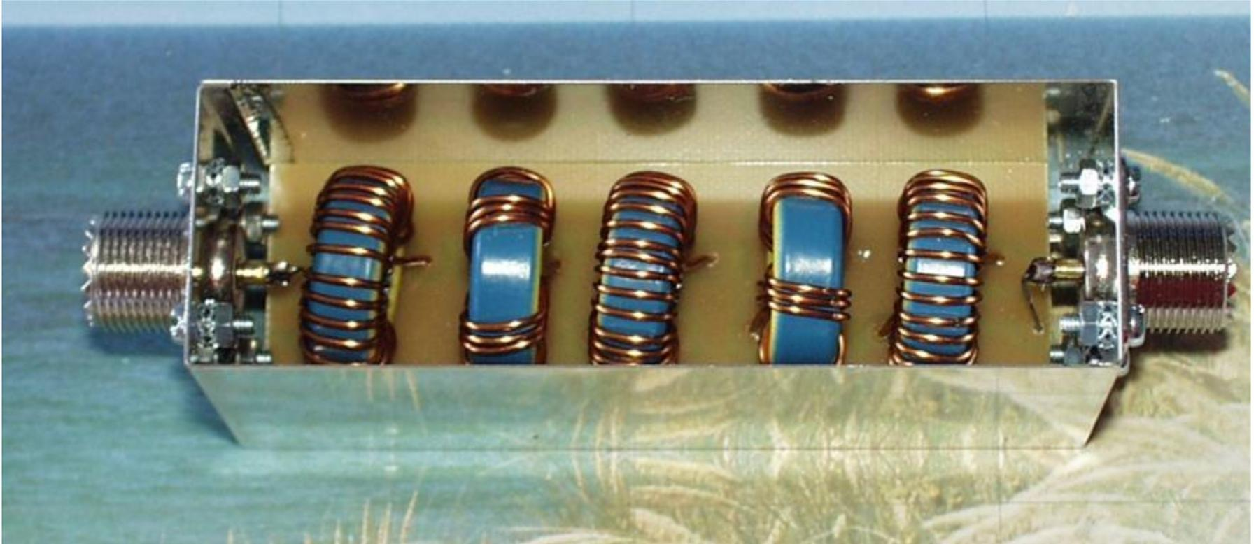
Schaltung sieht kompliziert aus, der Aufbau nicht: Alle C sind SMD auf der Leiterseite, die beiden Spulen für die Pole sind kleine T50-6 Ringkerne
