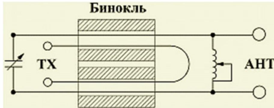
Aufbau des Trafos nach RZ3AE
