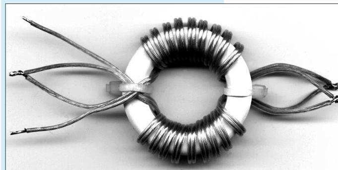
**Bild 2: Nach DG0SA gewickelter 1:4-Balun, zur Messung vorbereitet**
